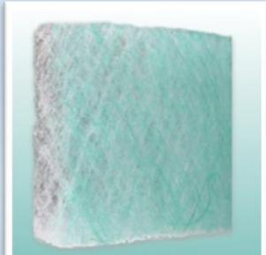
Фильтр “Paint-stop” состоит из слоев стекловолкна, соединенных между собой синтетической смолой, имеет прогрессивную плотность в направлении движения воздуха. Обладает высокой пыленакопительной способностью, устойчив к высоким температурам. В основном применяется для сбора излишков краски при нанесении методом распыления.
