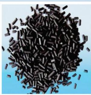
Кассеты с активированным углем используются для поглощения летучих загрязнителей и запахов. Каркас изготовлен из оцинкованной стали, оббивка из мелкой сетки. Внутри засыпан актив. уголь в форме цилиндрических гранул. Активированный уголь имеет с хорошо развитую пористую структуру и поэтому обладает очень большой удельной поверхностью на единицу массы, вследствие чего обладает высокой адсорбцией.
